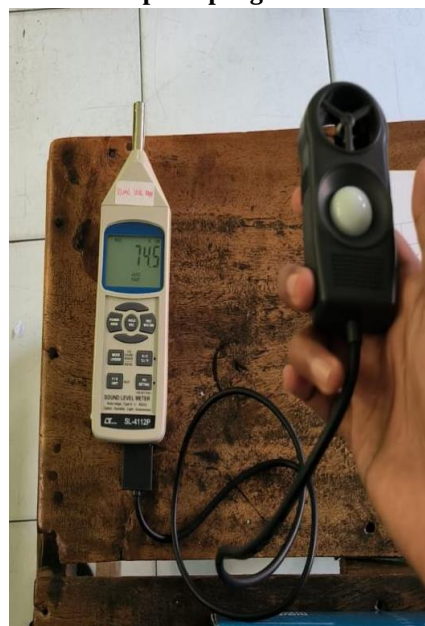
(Gambar 2 Inspeksi pengukuran pencahayaan)
